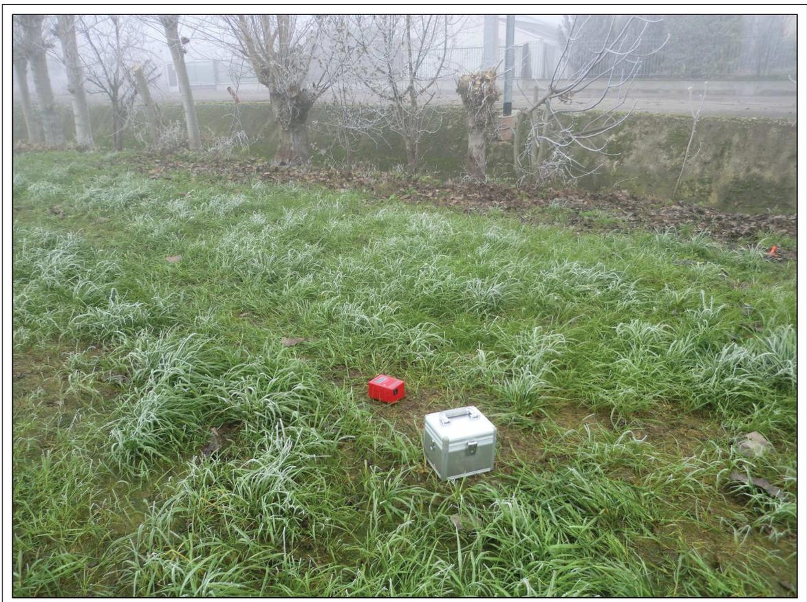
**Fig. 8 - Esecuzione dell'indagine sismica con stazione singola HVSR - H7 (18/12/2018)**
