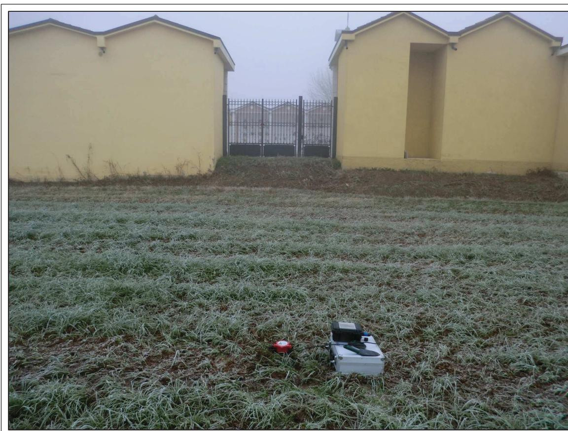
**Fig. 4 - Esecuzione dell'indagine sismica con stazione singola HVSR - H4 (18/12/2018)**
