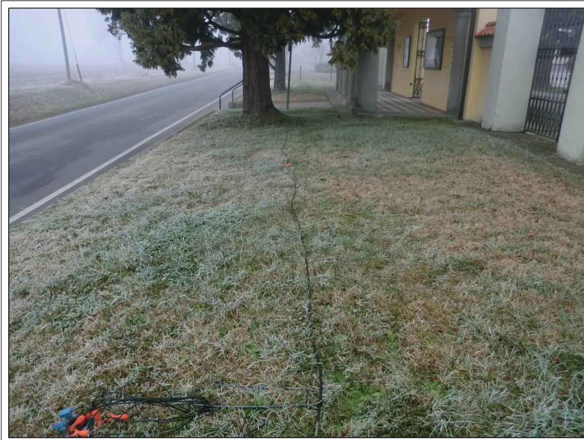
**Fig. 3 - Stendimento sismico per esecuzione della prova MASW-REMI MR2 (18/12/2018)**
