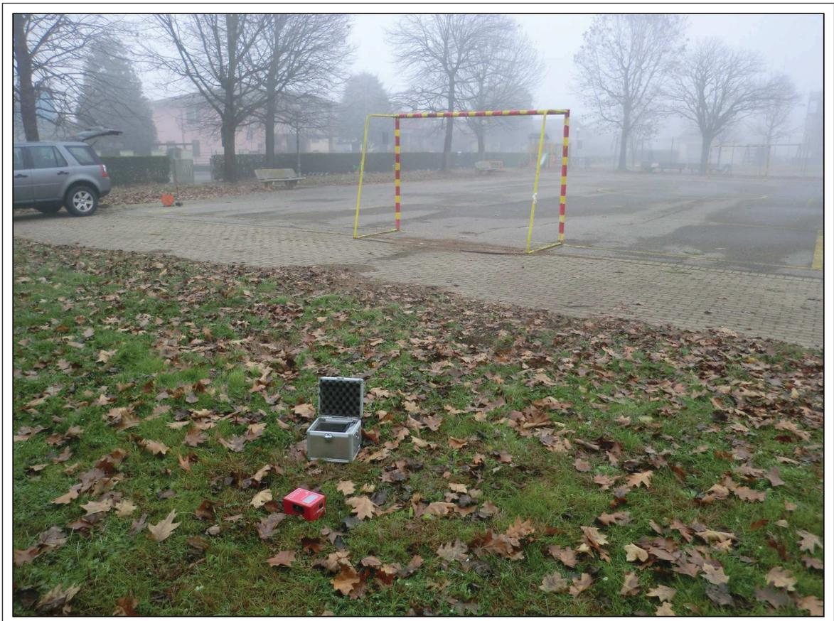
Fig. 6 - Esecuzione dell'indagine sismica con stazione singola HVSR - H5 (18/12/2018)
