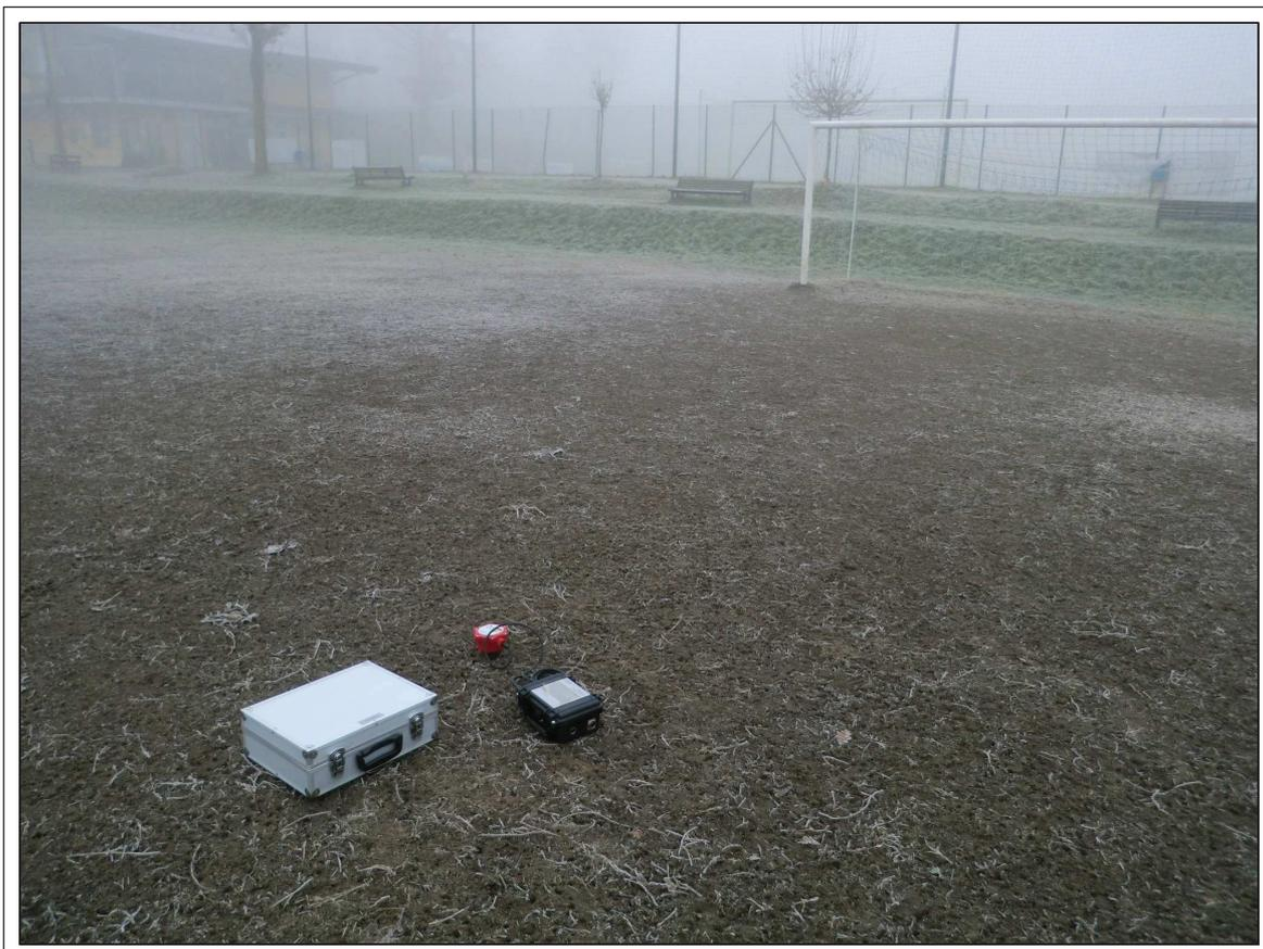
**Fig. 2 - Esecuzione dell'indagine sismica con stazione singola HVSR - H2 (18/12/2018)**
