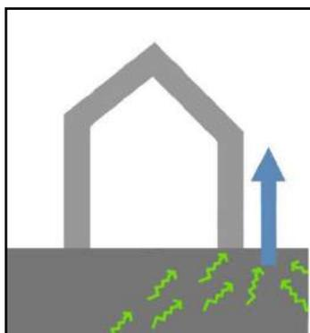
Fig. 3: depressione del sottosuolo con aspiratore perimetrale
