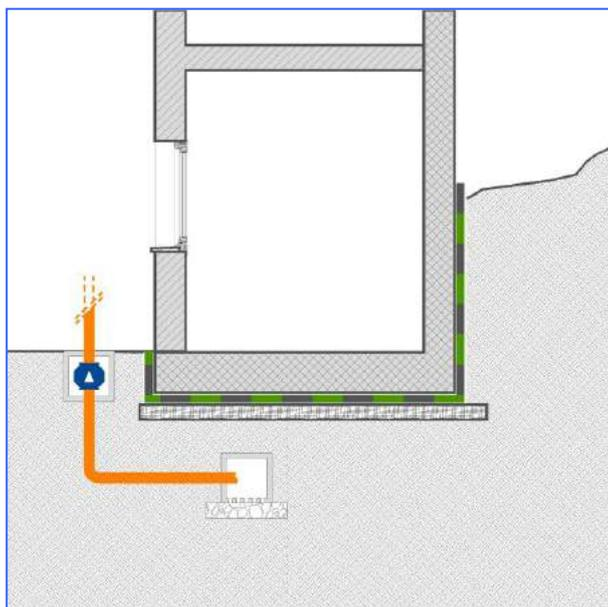
Soluzioni sicuramente più efficaci per quanto riguarda la protezione dall'umidità e anche da infiltrazioni di radon dalla muratura controterra consiste nel realizzare uno scannafosso fra terreno e muratura così da allontanare il terreno e attivare una buona circolazione d'aria. In questo caso la membrana verticale, peraltro sempre consigliabile, può anche essere evitata.
