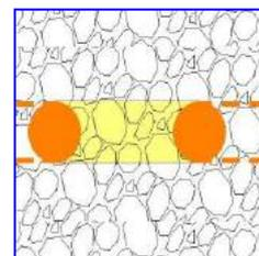
Tubazione in pvc, diametro normalmente 100-120 millimetri, salvo altre esigenze di progetto, all'estremità superiore collegata al ventilatore e destinata ad aspirare il radon nel terreno.
