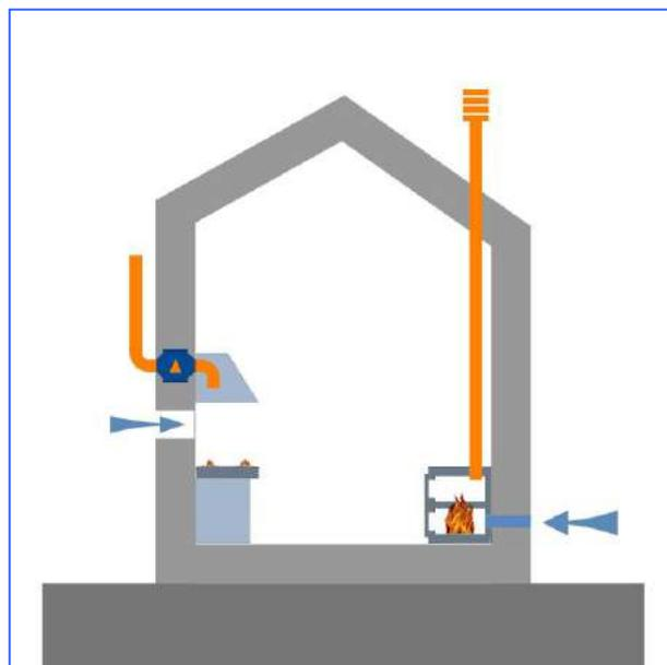
Fra le possibili tecniche di bonifica di edifici esistenti con eccessive concentrazioni di radon vi è quella della ventilazione indoor che consiste nell'aspirare l'aria dall'ambiente tramite un ventilatore posto sulla parete perimetrale o sull'infisso.
