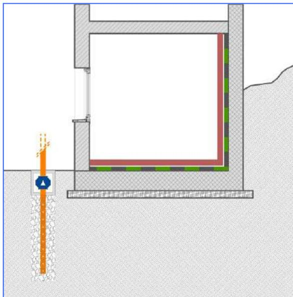
In una situazione di questo tipo ancora più funzionale risulta la realizzazione di una intercapedine ventilata meccanicamente realizzata all'interno dell'edificio tramite la messa in opera di casseri a perdere in plastica (igloo) di basso spessore sia sul solaio a terra che sulla parete verticale controterra, previa messa in opera di una membrana impermeabile e con successivo rivestimento a pavimento e a parete.
