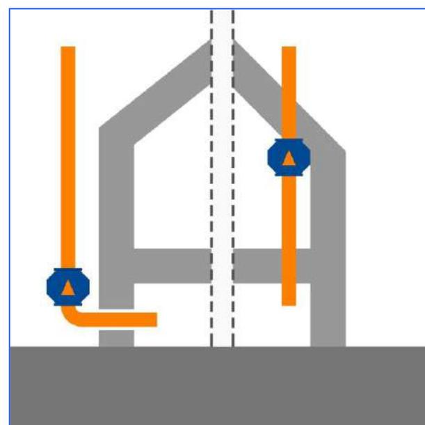
Nelle eventualità il percorso delle tubazioni di evacuazione sia all'interno dell'edificio, è importante porre il ventilatore nel luogo più alto vicino al punto di uscita dell'aria e del gas in atmosfera in modo che l'intera canalizzazione sia in depressione. In questo modo, laddove ci siano delle perdite lungo il condotto dovute a un errato assemblaggio dei tubi, non si avranno delle dispersioni di gas all'interno dell'edificio.
