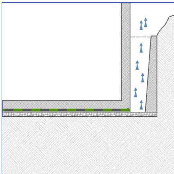
In alternativa allo scannafosso, più semplice da realizzare e meno invasiva, è la realizzazione di una parete controterra ventilata con appositi elementi ventilanti in plastica che realizzano una intercapedine che consente il transito dell'aria fra terreno e muratura.
