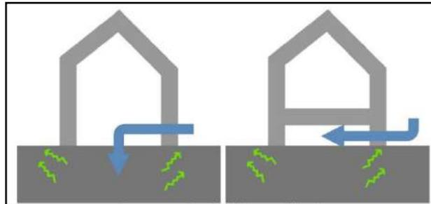
Fig. 4: pressurizzazione del terreno o del vespajo
