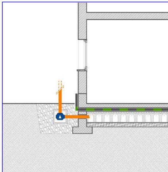
Se questa tipologia di vespaio sottostà a un volume interrato potrà essere predisposto un sistema ventilante in fase di costruzione.
